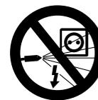
Ne pas nettoyer les équipements électriques, branchements et câbles sous tension avec le jet haute pression ou au jet d'eau – **Risque de court-circuit !**
