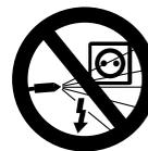
No mojar sistemas eléctricos, empalmes ni cables conductores de corriente con el chorro de alta presión o la manguera – **¡peligro de cortocircuito!**
