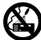
Gerät selbst und andere Elektrogeräte niemals mit dem Hochdruckstrahl oder dem Wasser-schlauch abspritzen – **Kurzschlussgefahr!**
