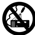
Ne jamais nettoyer l'appareil lui-même et d'autres appareils électriques avec le jet haute pression ou au jet d'eau – **Risque de court-circuit !**
