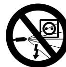
Não lavar as instalações eléctricas, as conexões e as linhas percorridas por corrente eléctrica com o jacto de alta pressão ou a mangueira de água – **perigo de um curto-circuito!**
