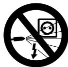
Elektrische installaties, aansluitingen en stroomgeleidende kabels niet met de hogedrukstraal of een waterstraal afspuiten – **kans op kortsluiting!**
