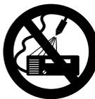
Non spruzzare mai l'apparecchiatura stessa ed altre apparecchiature elettriche con il getto AP o con il flessibile dell'acqua – **pericolo di corto circuito!**
