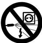
Non spruzzare impianti elettrici, giunti e condutture sotto tensione con il getto AP o con il flessibile dell'acqua – **pericolo di corto circuito!**
