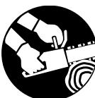
**Sujetar la motosierra con ambas manos – alto riesgo de accidente:** la mano derecha, en la empuñadura de mando – también los zurdos. Para guiarla de forma segura, asir firmemente el asidero tubular y la empuñadura con los pulgares.
