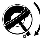
Colocar correctamente el cierre de aleta plegable (cierre de bayoneta), girarlo hasta el tope y plegar el estribo.
