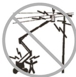
Manténgase alejado de la máquina si esta hace contacto con líneas eléctricas activas. Ninguna persona, ya se encuentre en el suelo o en la plataforma, debe tocar ni manejar la máquina hasta que las líneas eléctricas activas hayan sido desconectadas.
