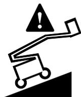
Si suena la alarma de inclinación con la plataforma elevada, se ilumina la luz indicadora de máquina no nivelada y la función de desplazamiento no funcionará en una o dos direcciones. Identifique el estado del brazo sobre la pendiente como se muestra a continuación.
