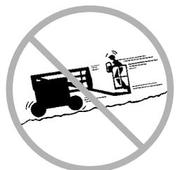
Adecue la velocidad de desplazamiento al estado del suelo, aglomeración, inclinación, ubicación del personal y cualquier otro factor que pudiera causar una colisión.
