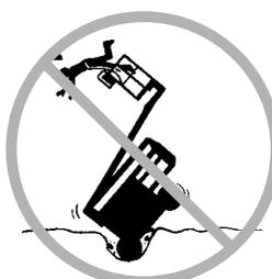
Extreme la precaución y utilice una velocidad baja al desplazar la máquina en posición replegada sobre terreno irregular, escombros, superficies inestables o resbaladizas o cerca de socavones y pendientes.
