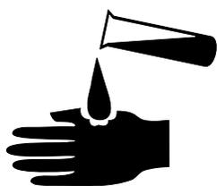
Las baterías contienen ácido. Utilice siempre ropa de seguridad y protección para los ojos cuando trabaje con baterías.
