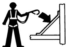
Los ocupantes deben llevar un cinturón o arnés de seguridad que cumpla la normativa vigente. Fije el cable de sujeción al anclaje de la plataforma.
