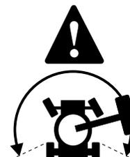
Para desplazarse, mantenga presionado el conmutador de activación de desplazamiento en cualquier sentido y aleje lentamente la palanca de control del centro.
