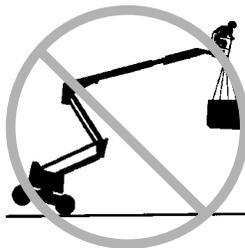
No coloque ni una cargas fijas o suspendidas a cualquier parte de la máquina.
