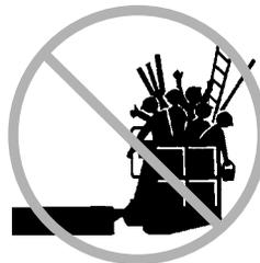
No coloque escaleras ni andamios en la plataforma ni los apoye en ninguna parte de la máquina.
